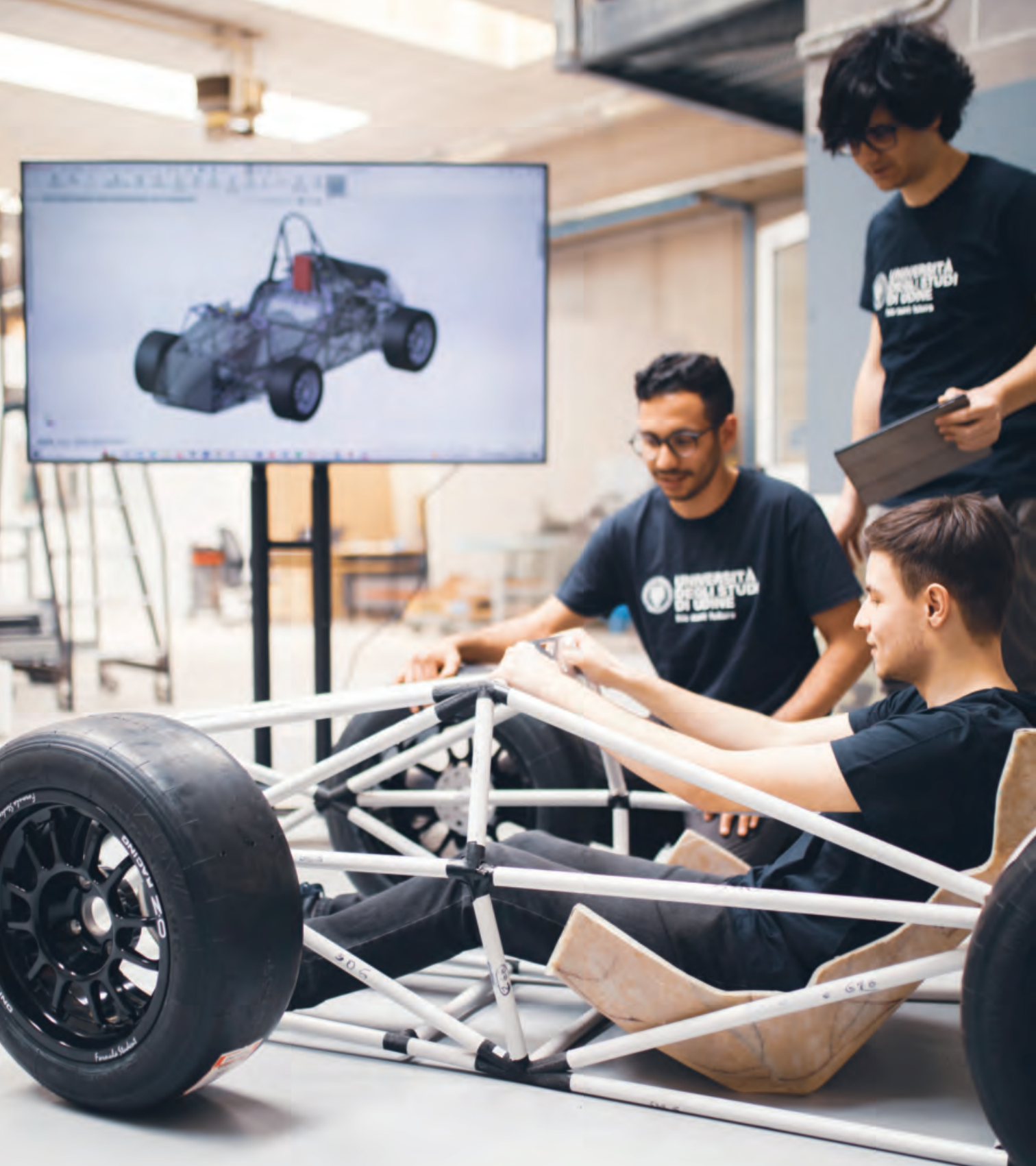
LABORATORIO TURBOMACHINERY AND ENERGY SYSTEMS LAB — PROGETTO E-RACING PER LA COSTRUZIONE DI UN PROTOTIPO DI MACCHINA ELETTRICA PER PARTECIPARE AL CAMPIONATO FORMULA STUDENT, PARTE DEL TEAM AL LAVORO PER VERIFICARE L'ERGONOMIA DELL'ABITACOLO.
